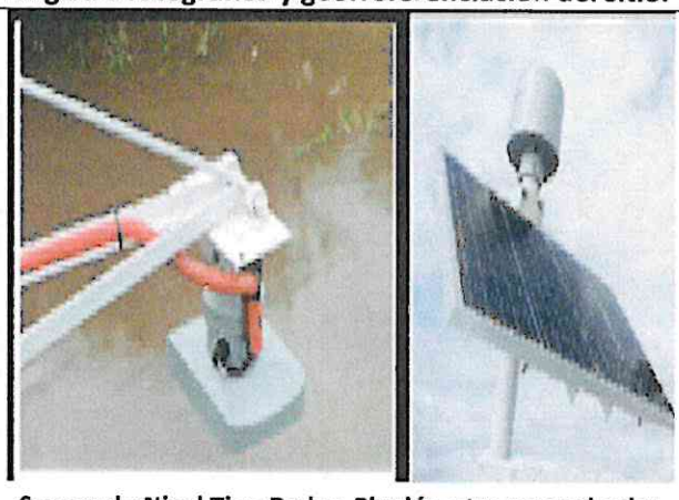
Sensor de Nivel Tipo Radar, Pluviómetro y panel solar
